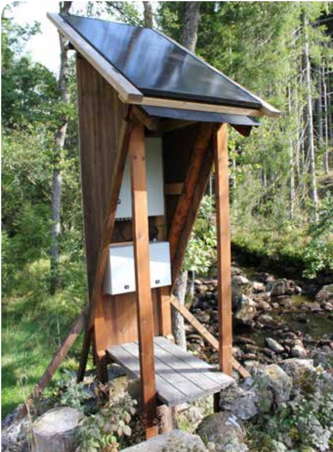
Den solcelledrevne pH-måleren i Spillingbekken, som befinner seg om lag 500 meter nedstrøms for selve kalkdosereren.
